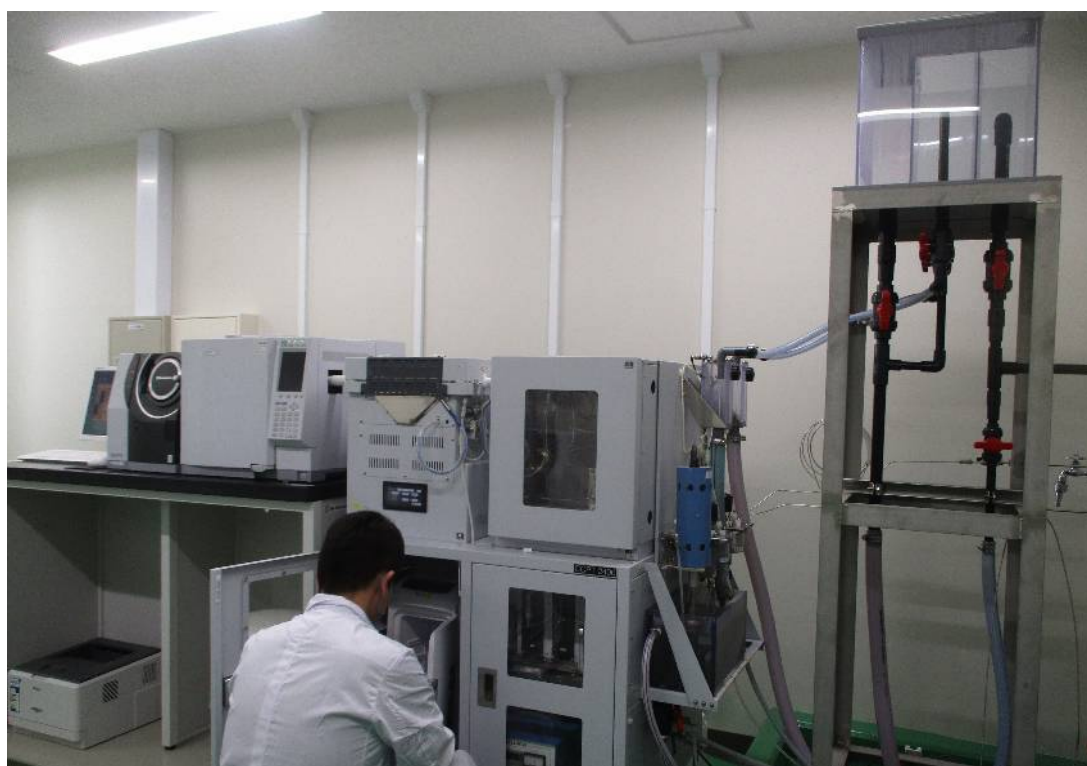
(西長沢浄水場 かび臭センサー (ガスクロマトグラフ-質量分析計))
