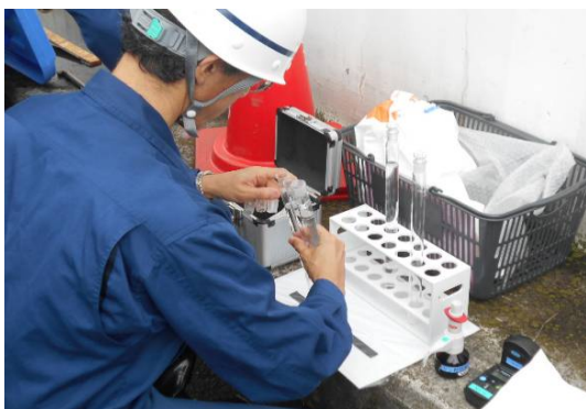
水質検査 (濁度測定)
