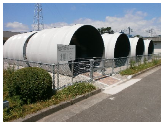
内径 3,100mm 導水管備蓄資材（飯泉取水管理事務所内）
