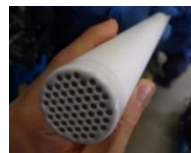
伊勢原浄水場運転管理委託受注者との共同研究（セラミック膜）
