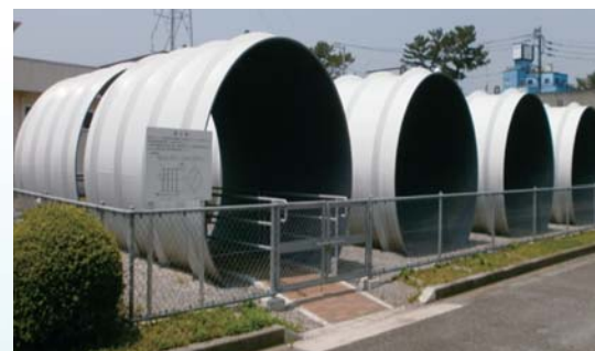
内径 3100 ミリメートル導水管（復旧資材備蓄品）
